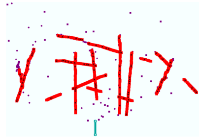
그림 11. 제안한 3-of-5 탐지 정책의 PRF 집합 선정 방법을 이용한 12개 표적의 능동추적 시험결과 Fig. 11. The active tracking test result for the scenario of 12 targets using the proposed method of selection of PRF set for 3-of-5 binary integration.
