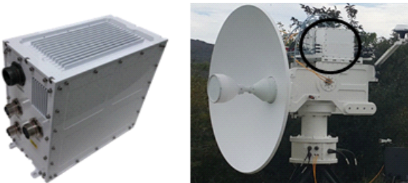
그림 11. 모노펄스 수신기 Fig. 11. The fabricated monopulse receiver.
